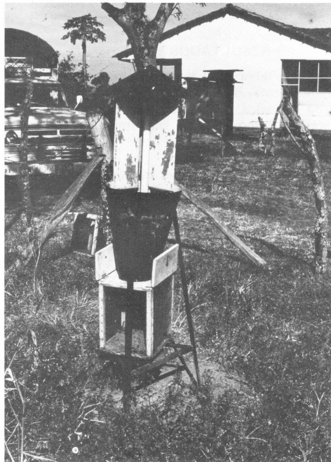
Figura 1. Trampa de luz negra tipo Hiestand utilizada para la captura de adultos de D. saccharalis .
